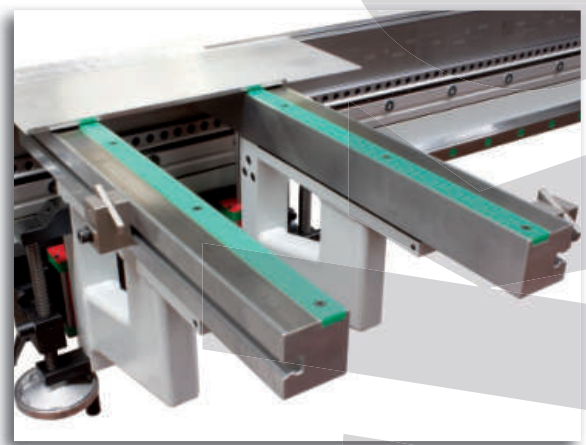
Höhenverstellbare Auflagearme, zur Anpassung an verschiedene Werkzeughöhen
