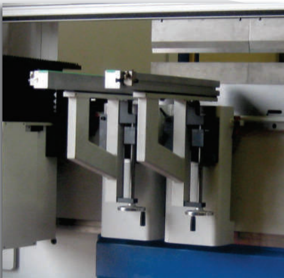
Höhenverstellbare Auflagearme in schwerer Ausführung für hohe Belastungen
