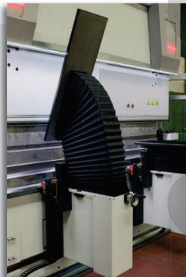
CNC-gesteuerte Biegeunterstützung zur Entlastung des Maschinenbediener und der Vermeidung von Kontrabiegungen
